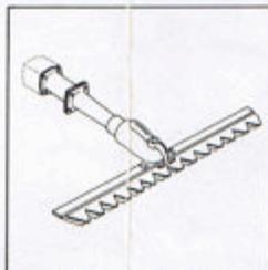
**Faucheuse frontale à barre de coupe.** Diamètre de coupe : 1,20 m. Entraînement direct. Permet de récupérer l'herbe.
