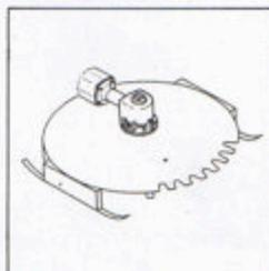
**Débroussailleuse circulaire spéciale.** Munie d'un capot échancré. Permet d'éliminer des arbres jusqu'à 5 cm de diamètre.
