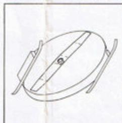
**Débroussailleuse circulaire.** (Vue intérieure). Equipée d'une lame forestière de 80 cm. Coupe et broie la végétation.
