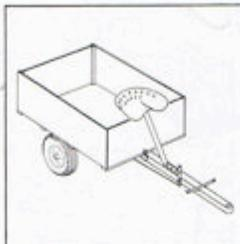
**Remorque basculante avec siège.** Charge utile : 400 kg.
