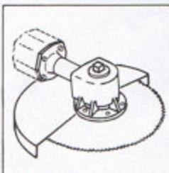
**Scie circulaire.** Diamètre : 50 cm. Scie orientable. Peut être utilisée en position horizontale ou verticale.
