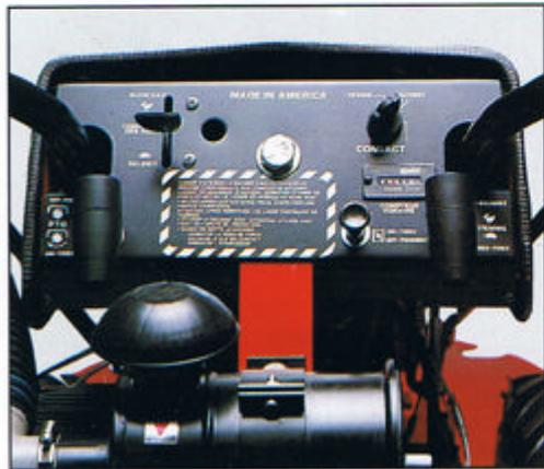
**DEMARRAGE ELECTRIQUE.** Pour accroître le confort d'utilisation sur certains modèles. Batterie 12 V - 42 AH.
