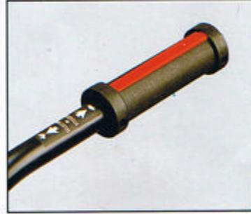
**CONTACTEUR DE SECURITE.** Contacteur de sécurité « arrêt moteur » sur chaque poignée (modèles 4 temps essence).
