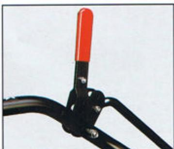
**CHANGEMENTS DES VITESSES D'AVANCEMENT.** Système « Swiftamatic » instantané pour adapter la vitesse d'avancement de la machine à la difficulté du travail. Une seule manette pour sélectionner les vitesses lentes ou rapides. Liaisons par tringles latérales rigides sans câble.
